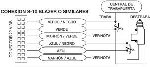
NOTA Si cierra por negativo, conectar a negativo. Si cierra por positivo, conectar a positivo.
