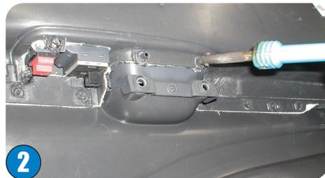
2 Coloque en el panel la nueva moldura y fijela con la ayuda de un soldador.
